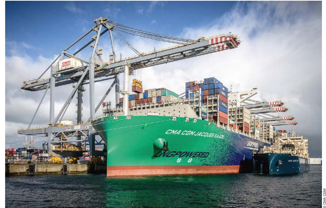
Le porte-conteneurs Jacques SAADE de la compagnie française CMA CGM, d'une capacité de 23 000 EVP (équivalents vingt pieds) propulsé au gaz naturel liquéfié. / The GNL powered 23,000 TEU (twenty-foot equivalent unit) container ship Jacques SAADE of the French company CMA CGM.
